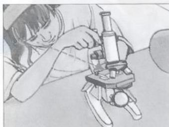
Descends l'objectif au plus près de la préparation en tournant la plus grosse vis. Surveille toujours le niveau de la platine pour éviter de briser la lamelle.
