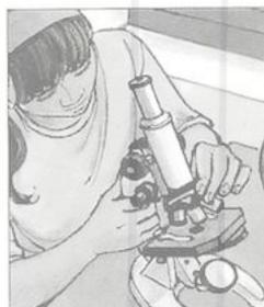
Règle le diaphragme sur l'ouverture maximale. Tourne la tourelle pour enclencher l'objectif le plus faible. Place ton œil contre l'oculaire : tu dois voir un cercle éclairé. Oriente le miroir pour obtenir un éclairage maximal, mais non
