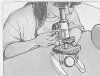
Procède alors à une mise au point plus précise avec la vis micrométrique. Ne redescends jamais l'objectif quand tu as l'œil contre l'oculaire : tu risques de heurter ta préparation. En revanche, tu peux faire glisser la lame sur la platine. Attention : tes mouvements seront alors amplifiés et inversés.
