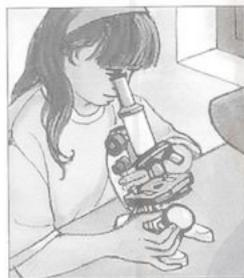
Avant de mettre ta préparation, occupe-toi de l'éclairage. Si tu utilises une lampe (ampoule de 40 watts maximum), oriente-la vers le miroir sous la platine.
